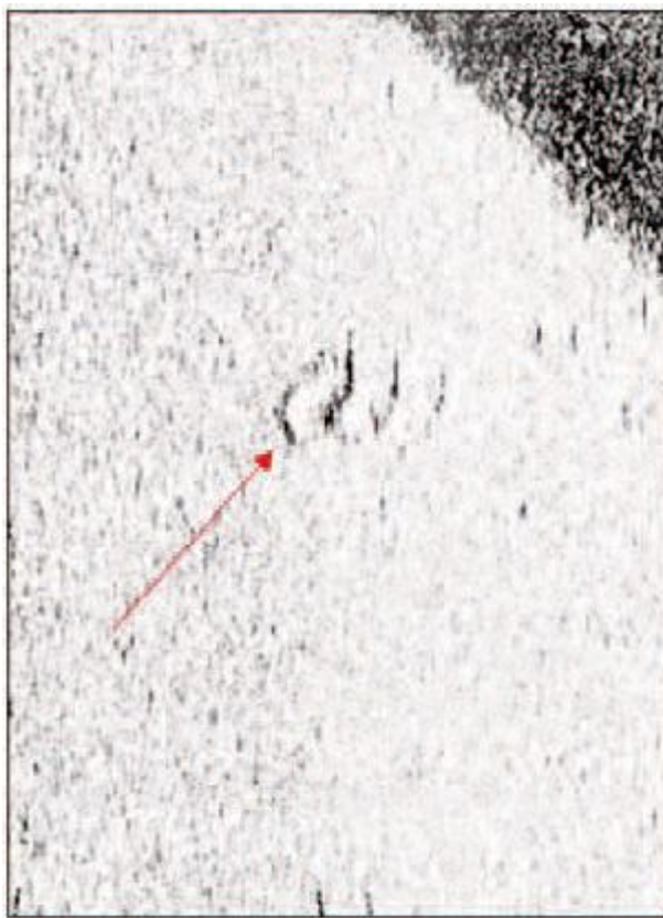
Figura 18 Rilievo SSS. Anomalia SS4 la cui forma è riconducibile ad una piccola imbarcazione.
