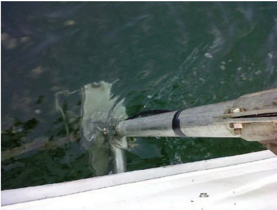
Figura 7 Trasduttore dell'ecoscandaglio RESON SEABAT 8125 durante una fase dei rilievi. Figure 7 Transducer of RESON SeaBat 8125 multibeam during the surveys.
